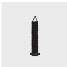
Parafusos tipo M4x30 (02) (Ponta cônica)
